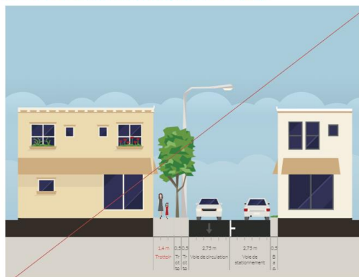
Exemple de profil de voirie résidentielle à double sens de circulation - (à titre indicatif)
